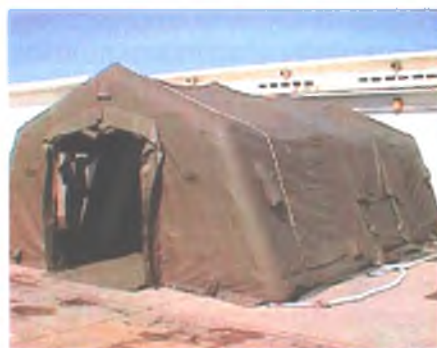
Пневмокаркасные укрытия западных фирм (Швеция, Германия)
