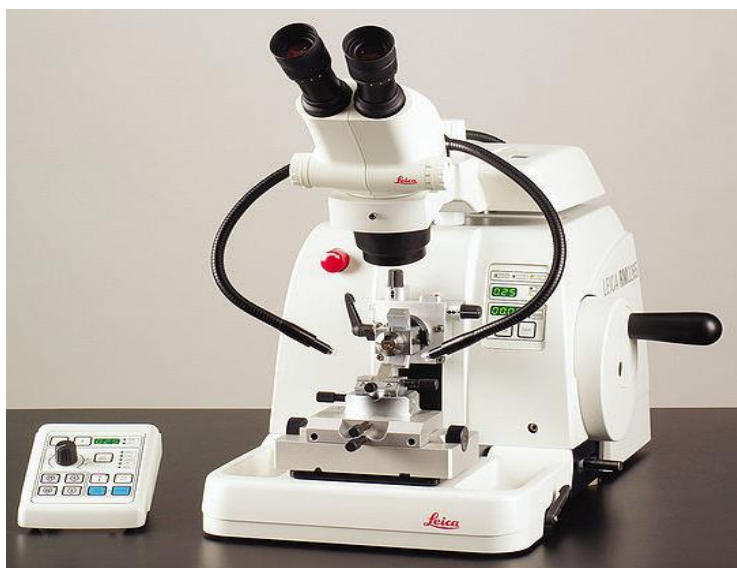
15 – сурет. Ультрамикротом 2265 EM GD MB (микроскоппен біріктірілген).
